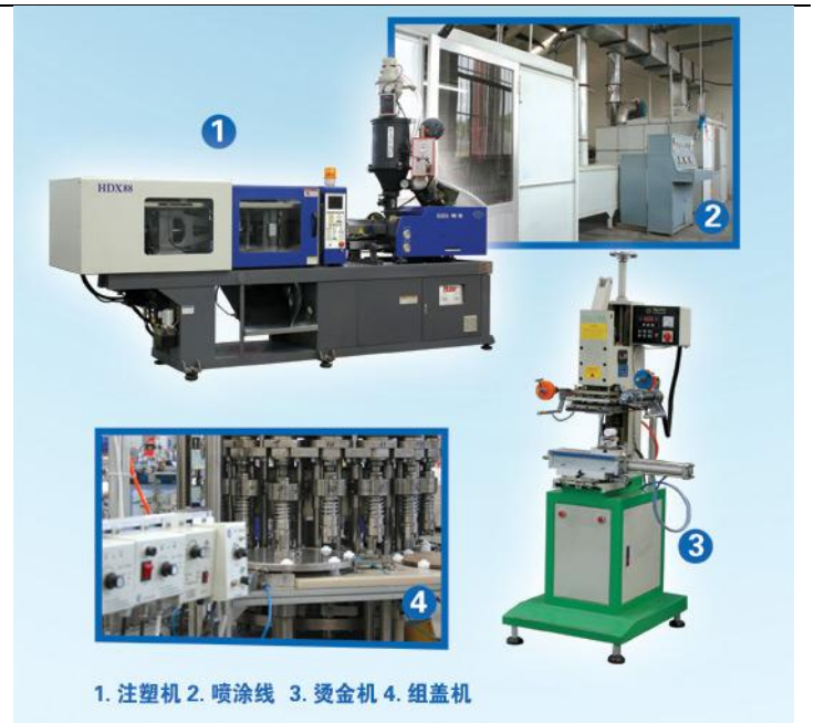
图 9 丽鹏股份塑料盖生产线
