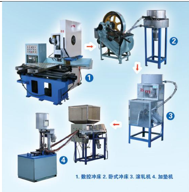
图 8 丽鹏股份铝盖生产线
