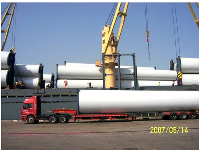
图 10: 风塔陆运用重型拖车
