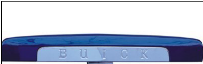
轿车尾门拉手 (集成牌照灯和触控开关)
