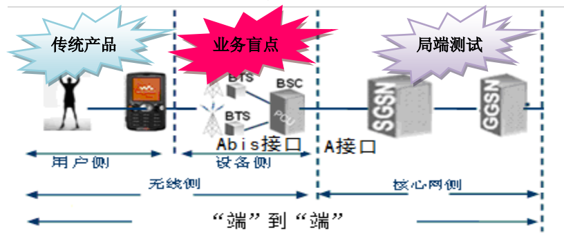
图 41：“端到端”网络测试方案覆盖业务盲点
