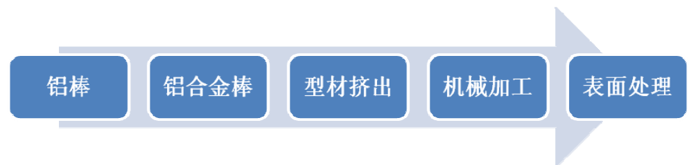
图 5: 车用铝合金内外饰件的生产过程
