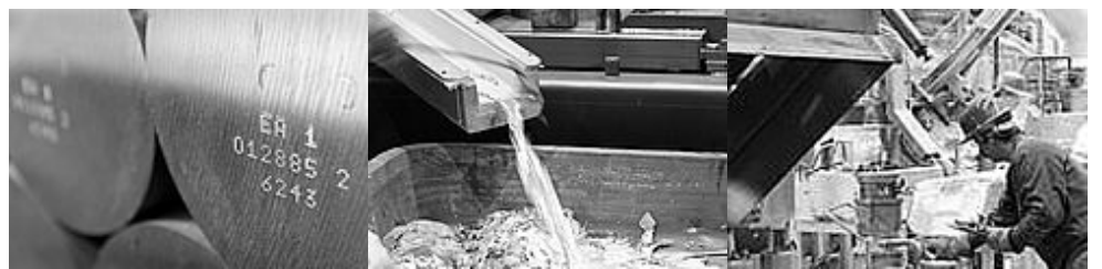
图 6: 车用铝合金内外饰件的生产过程: 铝棒->铝合金
