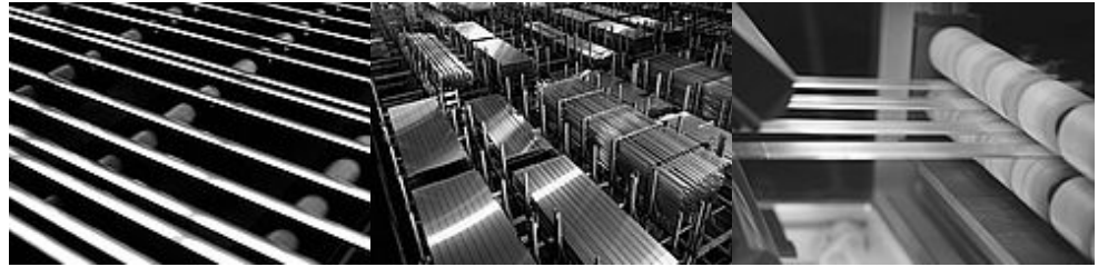
图 7： 车用铝合金内外饰件的生产过程：铝合金型材挤出
