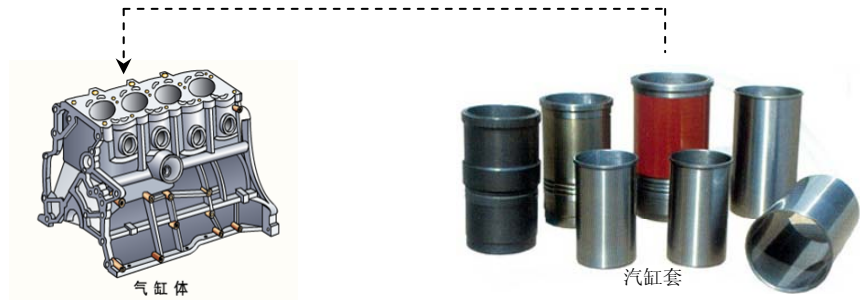
图 6：气缸套在发动机中的位置
