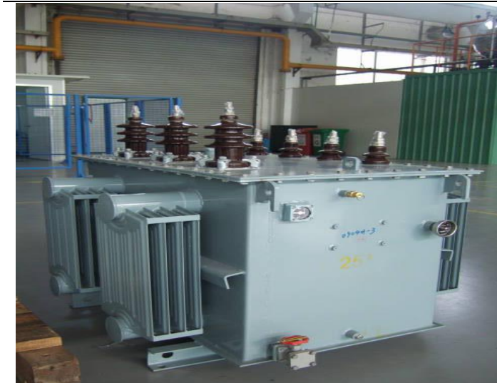
图 12：非晶合金变压器典型三相结构
