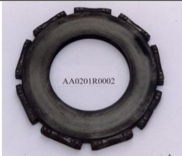
图 2: C/C 飞机刹车副盘
