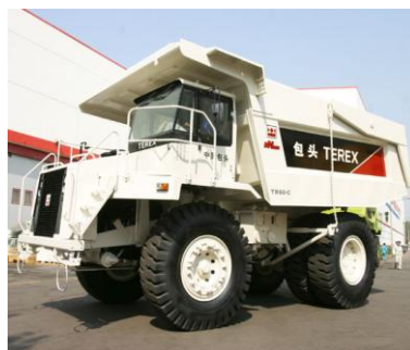
堆装容积 52.9 立方米的机械轮式 TR60-c 煤斗型矿用自卸车
