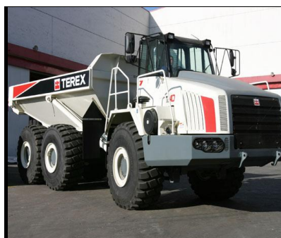
载重量 38 吨的 TA40 铰接式矿用自卸车
