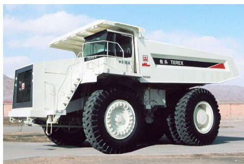
载重量 91 吨的 TR100 机械轮式岩斗型矿用自卸车
