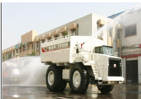
装载容积 85 立方米的 TR100-W 矿用洒水车
