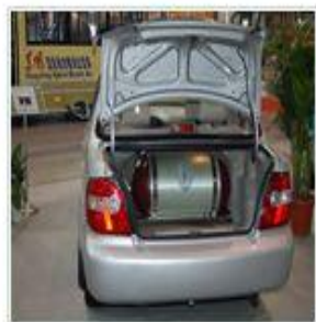
汽车用玻璃纤维缠绕气瓶
