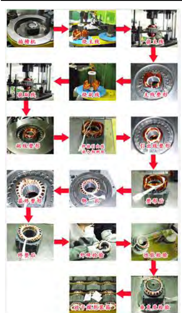
图表 12：电机定子生产流程
