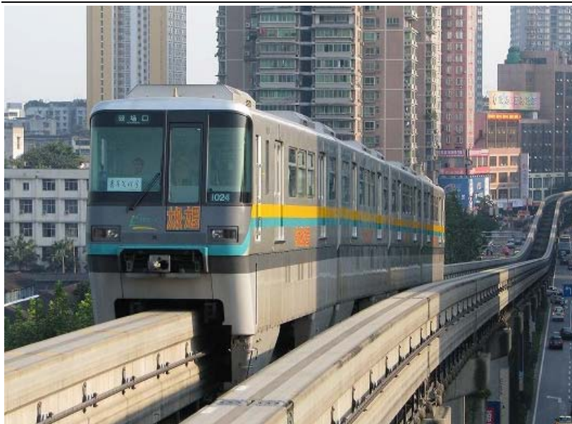
图表 55. 重庆轨道交通 2 号线运行的跨座式单轨列车
