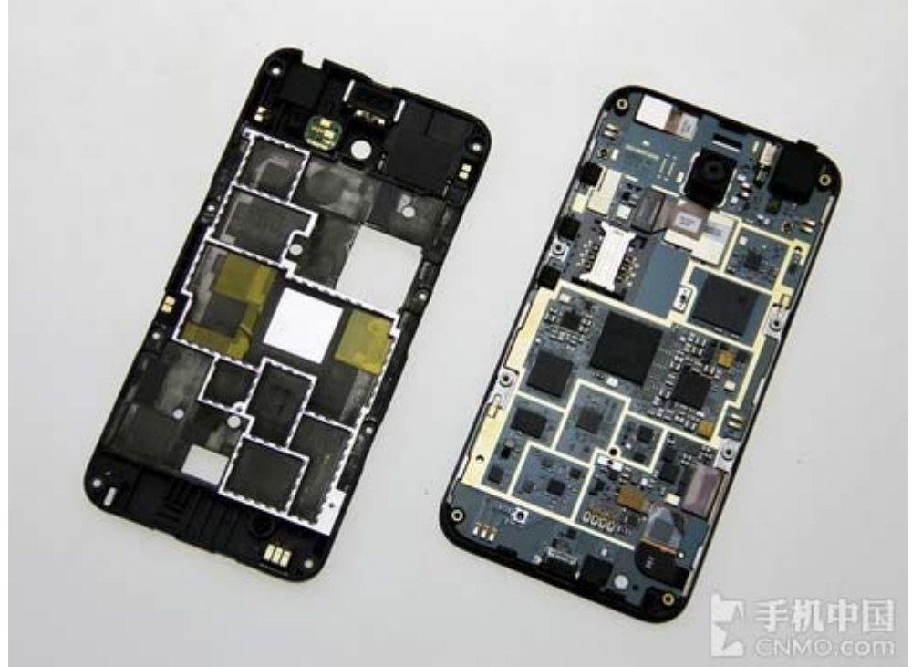
图表 41、小米 2 手机背板上的铝镁合金框架，起强固、支撑作用
