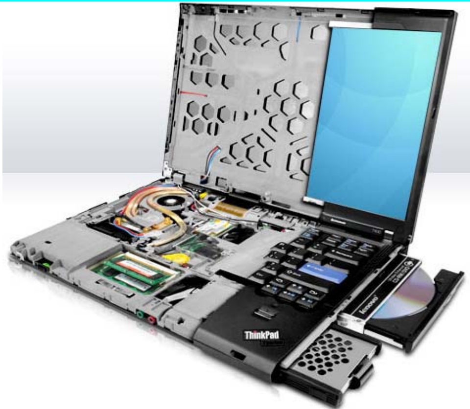
图表 31、Thinkpad 镁合金全蜂巢式的显示屏防滚落架
