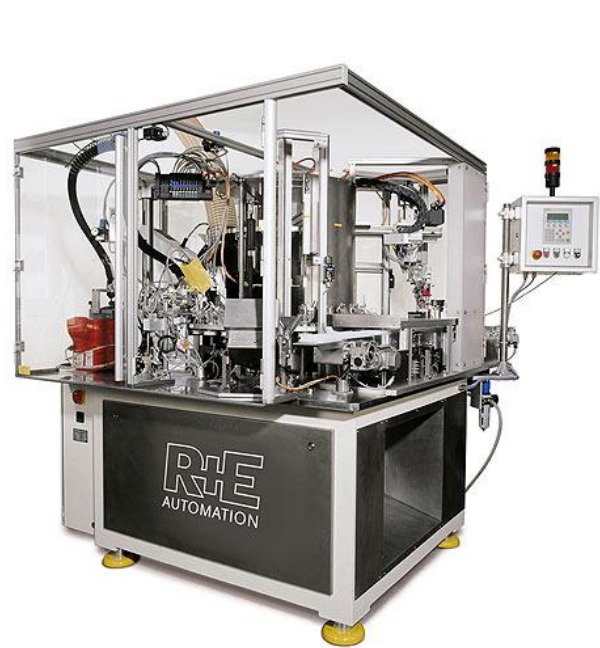
图 2: R+E 医用灌封注射器针尖的组装设备
