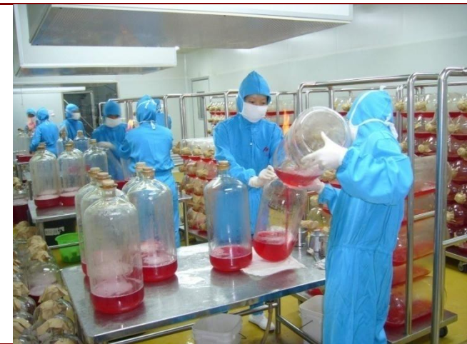
图 8：落后的转瓶培养生产模式
