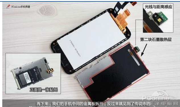
图 19: 小米手机使用的第二层石墨散热膜
