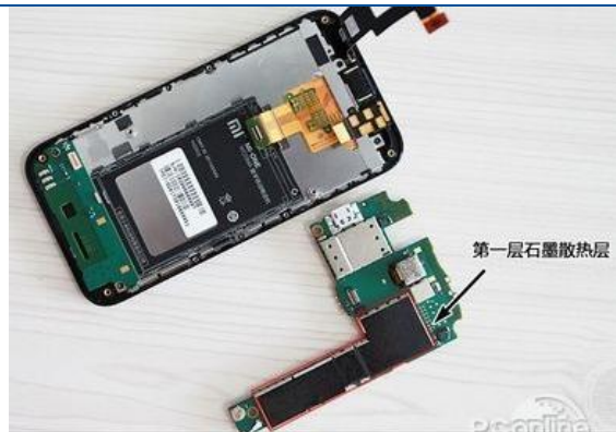
图 18: 小米手机使用的第一层石墨散热膜
