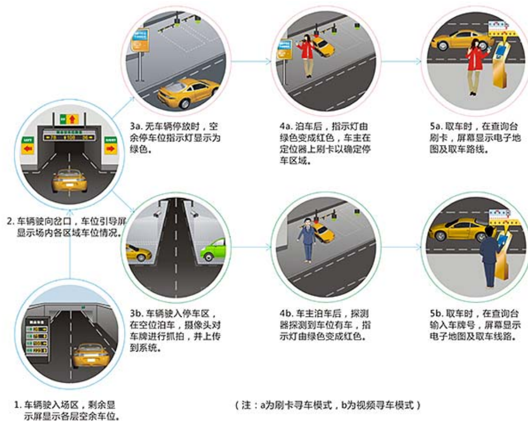
图 8：车位引导和反向寻车功能示意图
