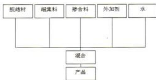
图 2：湿混砂浆生产工艺流程
