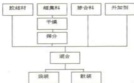
图 1：干混砂浆生产工艺流程
