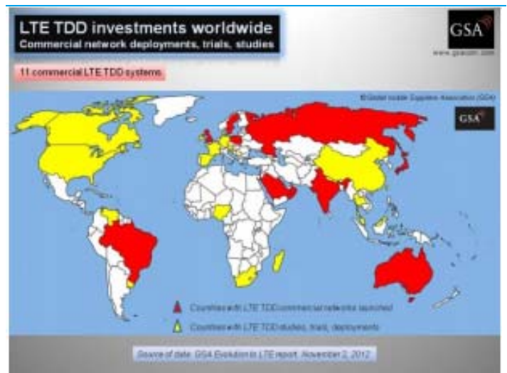
图表24: TD-LTE 运营商及部署现状 (全球共计 11 张网络商用, 17 个实验网, 主要部署在 2.6G、2.3G 频段)
