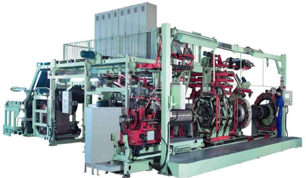
图表36: 公司产品全自动子午线轮胎成型机
