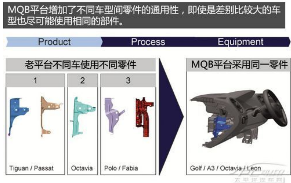
图 8: 大众 MQB 平台零部件通用性示意
