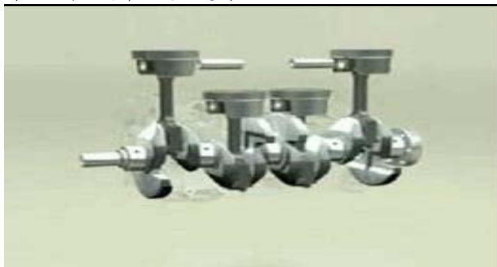
图 3: 曲轴、连杆、活塞示意图
