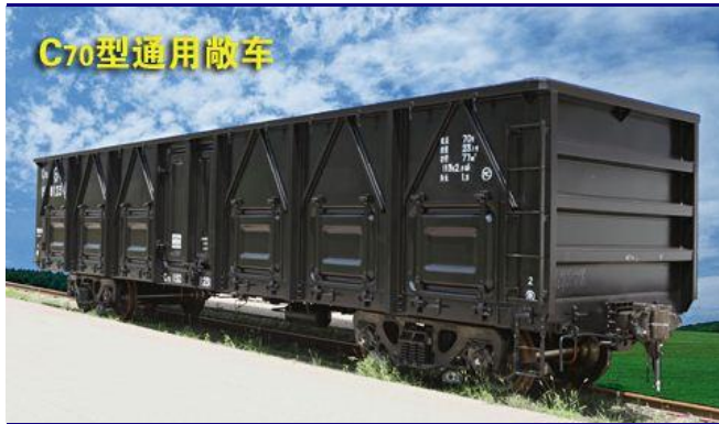
图 4：公司产品：铁路车辆=车体钢结构+2 转向架
