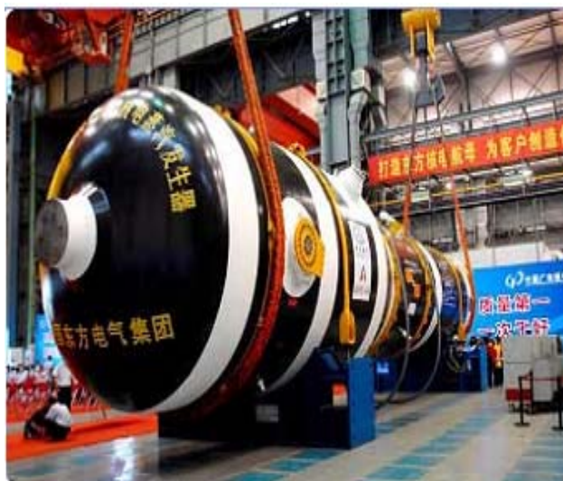
图表17核电站蒸汽发生器
