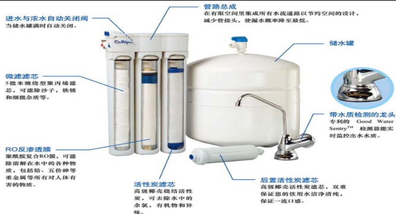
图 18： 某型号直饮机构造示意图
