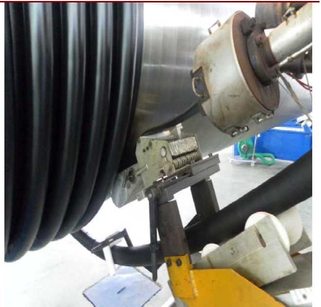
图 10: HDPE 缠绕增强管生产实景图
