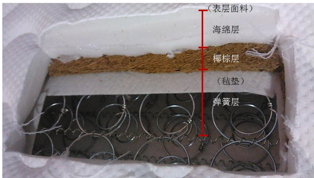
图 31：弹簧床垫的经典 5 层结构
