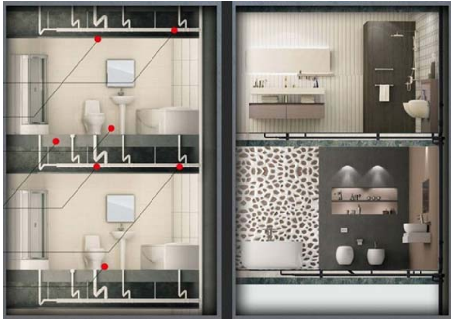
图 11 同层排水与传统隔层排水示意图
