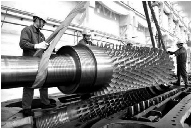
图 2: 正在吊装的轴流压缩机
