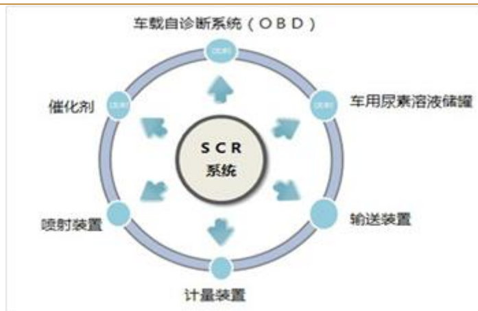
图 8：SCR 技术的排放控制原理
