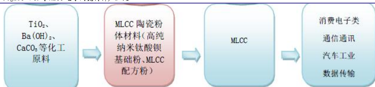
Figure 4 公司 MLCC 电子陶瓷材料产业链
