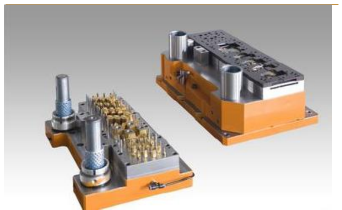
图 9：易损零配件——拉环模具系统
