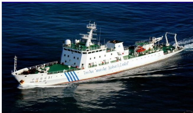
图 22: 中国海监 51 船: 1500 吨级 (中船重工武昌船舶重工)
