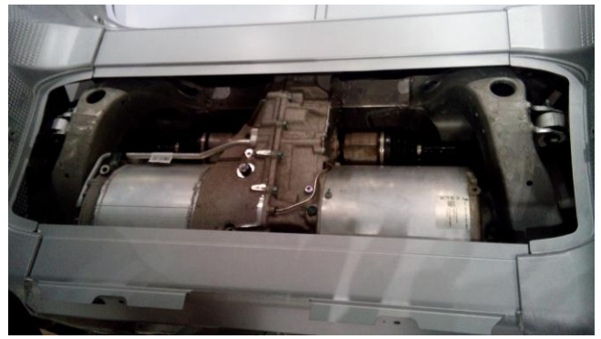
图 2：特斯拉采用转子电机驱动（后驱），需要电加热器模组在寒冷地区加热产生暖风。
