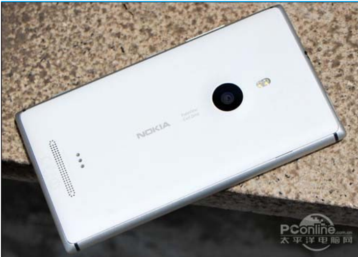
图表5: 诺基亚 Lumia 925 采用金属机壳
