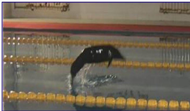
图 1：中科院自动化所全球首次实现机器海豚完全跃出水面
