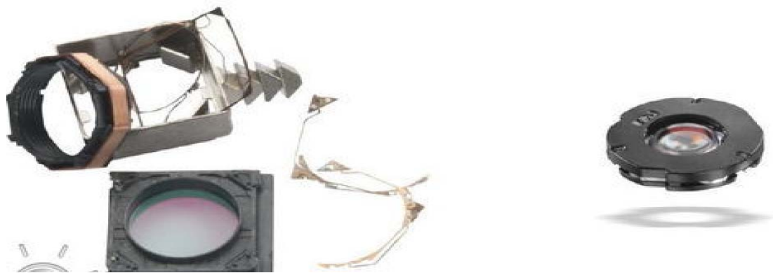
图表 3：传统VCM摄像头与MEMS摄像头对比
