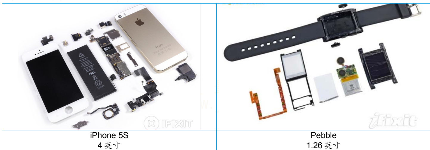
图表4: 智能手表 PCB 面积显著缩小
