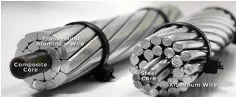
图 11: ACCC 导线（左）与 ACSR 导线（右）对比
