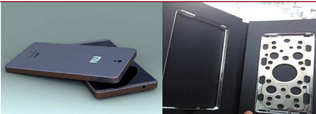
图 10: 小米 4 金属中框和边框一体化 (右图为样品)
