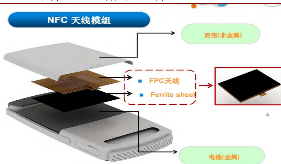
图 12：磁片是手机 NFC 天线模组重要组成部分
