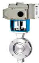
蝶阀采用了三维偏心原理设计，使密封面的空间运动轨迹达到理想化，解决了传统偏心蝶阀在启闭 $0^{\circ} \sim 10^{\circ}$ 瞬间密封面仍处于滑动接触摩擦的弊病，实现蝶板在开启瞬间密封面即分离，关闭接触即密封的效果，由于蝶阀自身构造及结构特点相对于其他阀门，具有结构长度短，体积小，耗用材料省更具有经济性。
