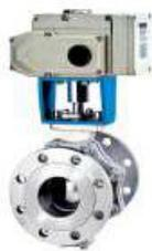
其结构采用可动硬密封座双向密封设计。双向密封阀座之间无间隙回转时具有很大的剪切力及自洁功能，球阀采用通径设计当阀全开时，其流通直径与管道直径基本相当，压力损失极小。其特点是密封性能好，流向不受限制，适用于各种气体、液体及含纤维和细小颗粒的介质尤其适用于控制纤维和微小固体颗粒的悬浊液及粘性介质的通断。
