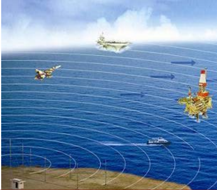
图 6：高频地波雷达应用示意图
