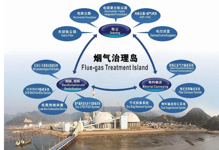
图 11：烟气治理岛一体化示意图
