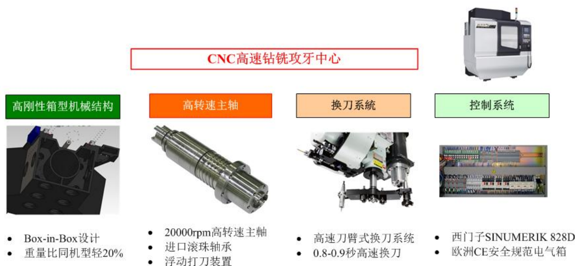
图表 64: CNC 高速钻铣攻牙中心主要配置
