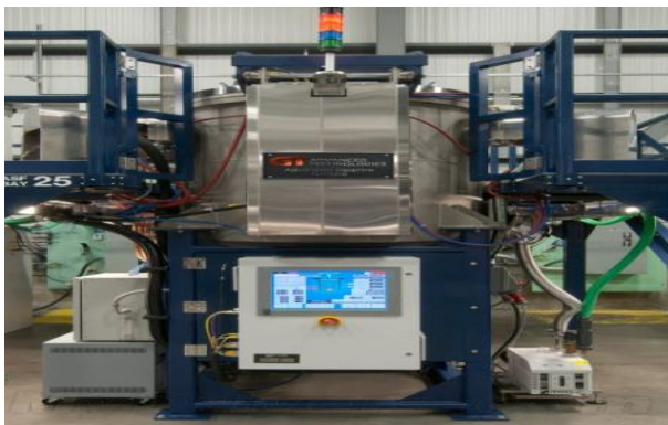
图表 26: GTAT 位于亚利桑那州工厂中使用的长晶炉
