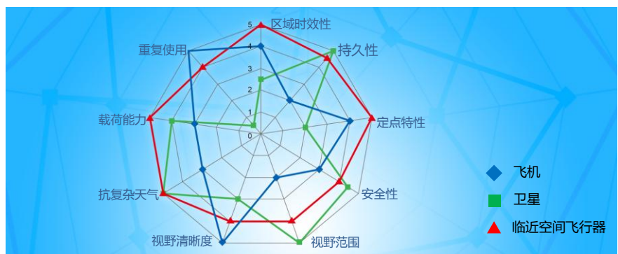
图 36: 光启的临近空间飞行器与飞机、卫星的对比
