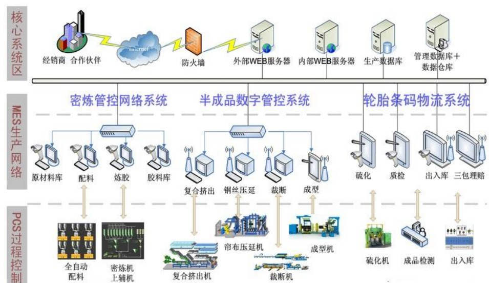
图表 2 公司给轮胎制造商提供全部环节装备及信息化系统
