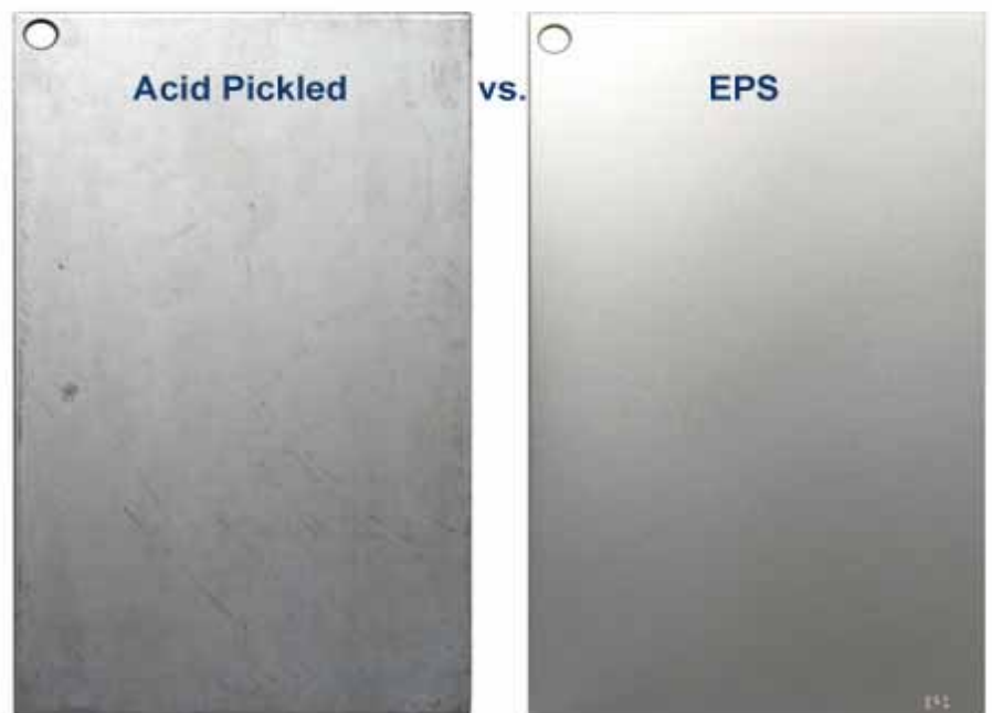
图表20: 传统酸洗和 EPS 处理后的钢材表面对比
