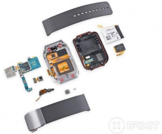
图表 13 Galaxy Gear 2 结构组件
