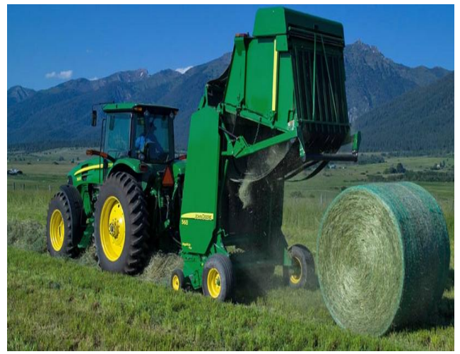
图 16: 搂草机+捆扎机，实现高效机械化生物质燃料收集
