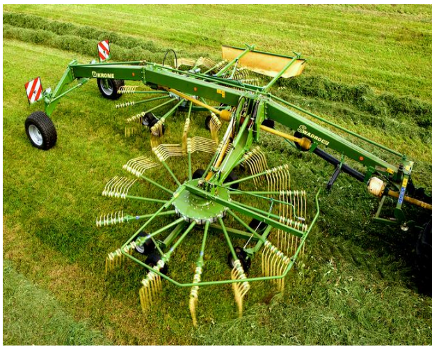
图 15: 搂草机+捆扎机，实现高效机械化生物质燃料收集
